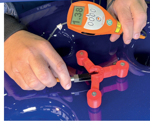
③ 3: Referenzmessung an einem Mannlo- deckel mit der Positionierhilfe / Refer- ence-Measurement of a manway cover with the positioning aid
